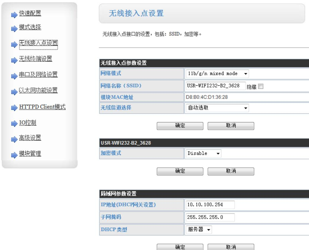
图10 无线接入点设置
