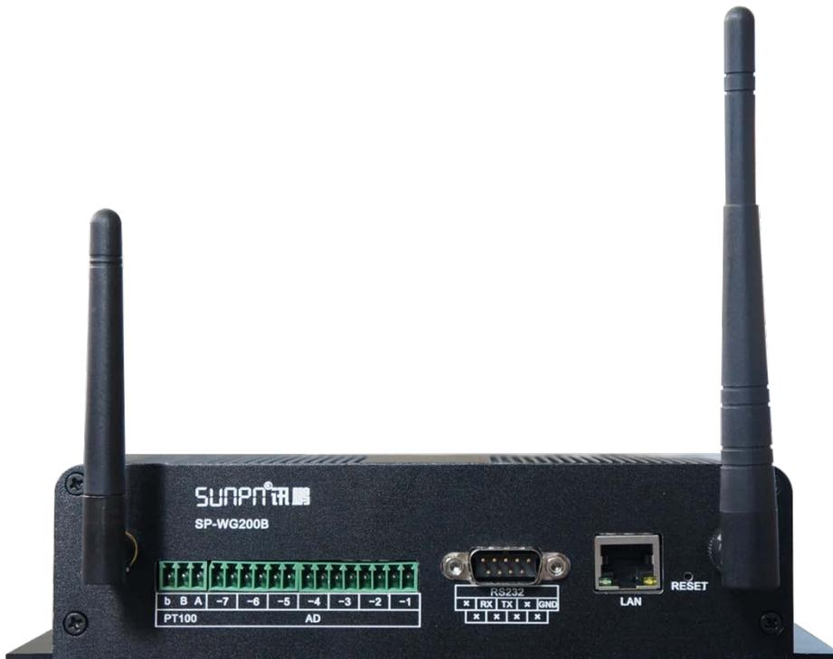
深圳讯鹏科技有限公司自主研发的SP-WG200B网关，采用业内工业级高性能嵌入式结构，针对智能制造、智能家居、智慧农场、工业控制、工厂设备等领域，将数据的采集与传输做了专业的一体化设计。使用此网关时，用户无需关心具体细节，只需简单设置即可实现以太网、WIFI、RS232、RS485、RF433、IO等设备之间的数据交换。网关自带输入输出、AD采集和温度测量等功能，用户发送简单指令即可方便采集设备的开关信号、计数信号、模拟量信号，也可以控制设备的输出状态，从而轻松实现物联网。
